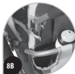
Enlever la roue du kit de conversion et le guidon avant de tirer la remorque. La roue pourrait s'accrocher sur le sol et le guidon pourrait s'accrocher à des obstacles imprévus dans les tournants.
