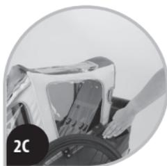
Déplier la capote de la remorque et fermer les attaches latérales. Figures **2A**, **2B** et **2C**.
