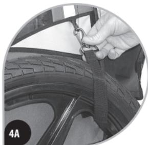
Pour utiliser la sangle, la sortir de l'anneau en D et l'enrouler autour de la roue à son point le plus bas – en l'accrochant de nouveau solidement à l'anneau en D. Figure 4A.
