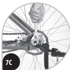
Enlever le boulon de la roue arrière. Attacher le boulon à déconnexion rapide à la roue. Resserrer le boulon de la roue arrière. Fixer la goupille à déconnexion rapide au bras d'attelage et verrouiller solidement. Figure 7A, 7B and 7C.
